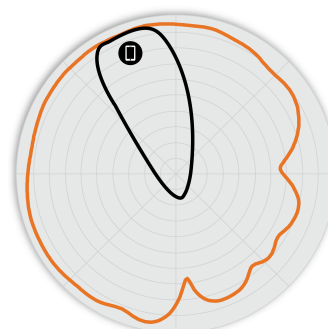
Attēls 5. H550 5GHz Elevation Antenna Patterns
