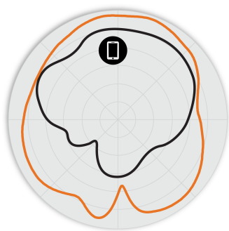
Attēls 3. H550 5GHz Azimuth Antenna Patterns
